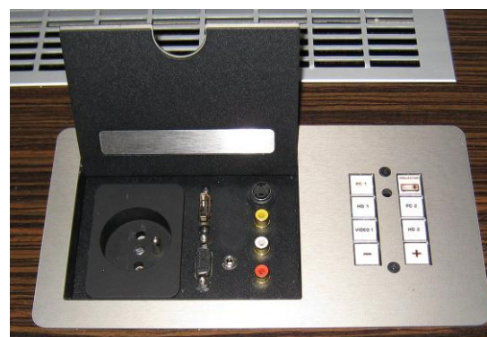
Konektorové pole s řídicí jednotkou, vstupy VGA, HDMI, video a s-video
